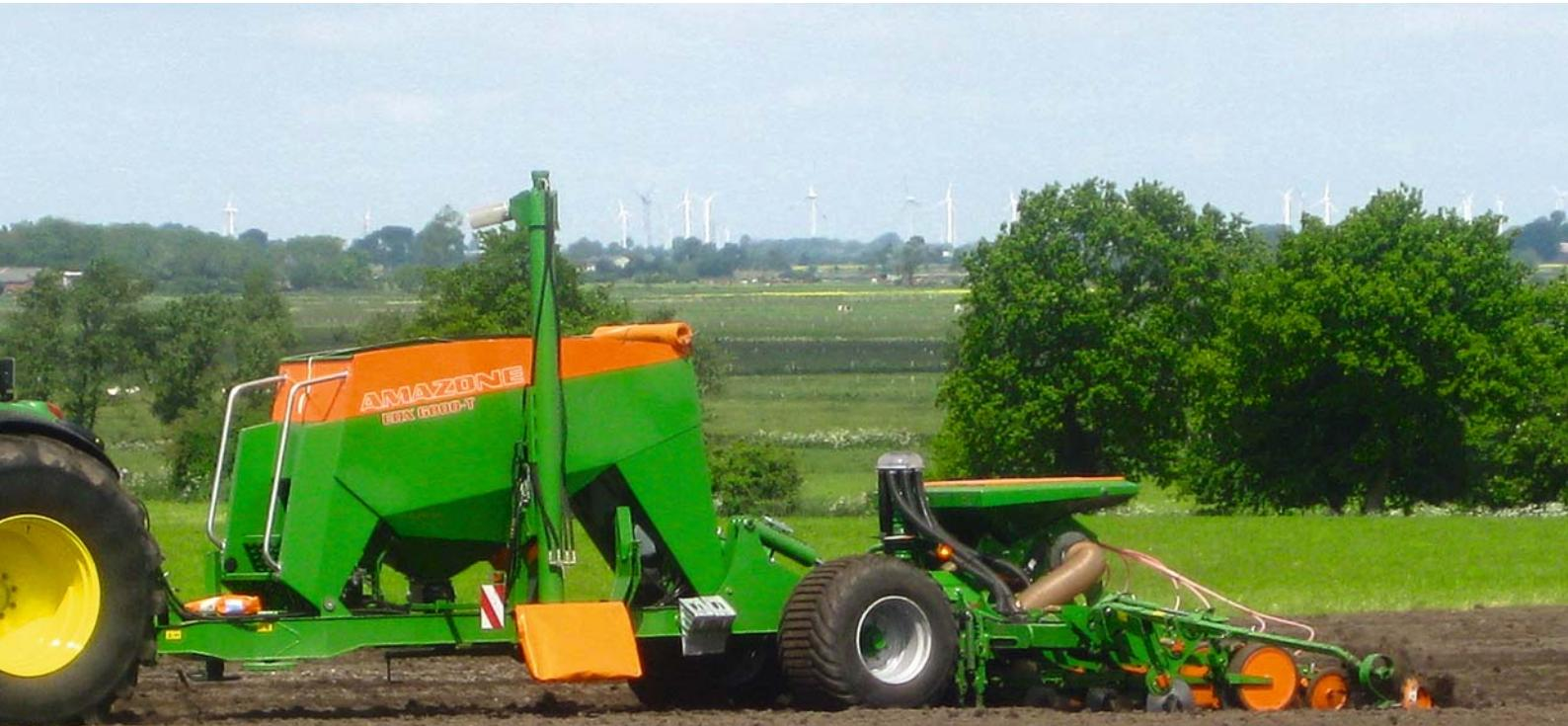
Точное пневматическое разделение семян производится на 8 рядов на центральных высевающих барабанах. Чистики на барабанах регулируются централизованно и синхронно. При желании сеялка EDX может быть оснащена и электронной системой дистанционной регулировки чистиков. Она обеспечивает удобную регулировку из кабины водителя, позволяющую компенсировать изменения свойств семян внутри партии.
