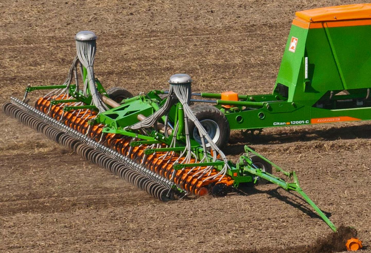
55 kg Druck belastet werden. Für die optimale Einbettung der Saat lassen sich die Maschinen wahlweise mit Exaktstriegel oder Rollenstriegel ausrüsten. Der Rollenstriegel kann völlig unabhängig vom Schar mit bis zu 35 kg Druck je Rolle belastet werden.
