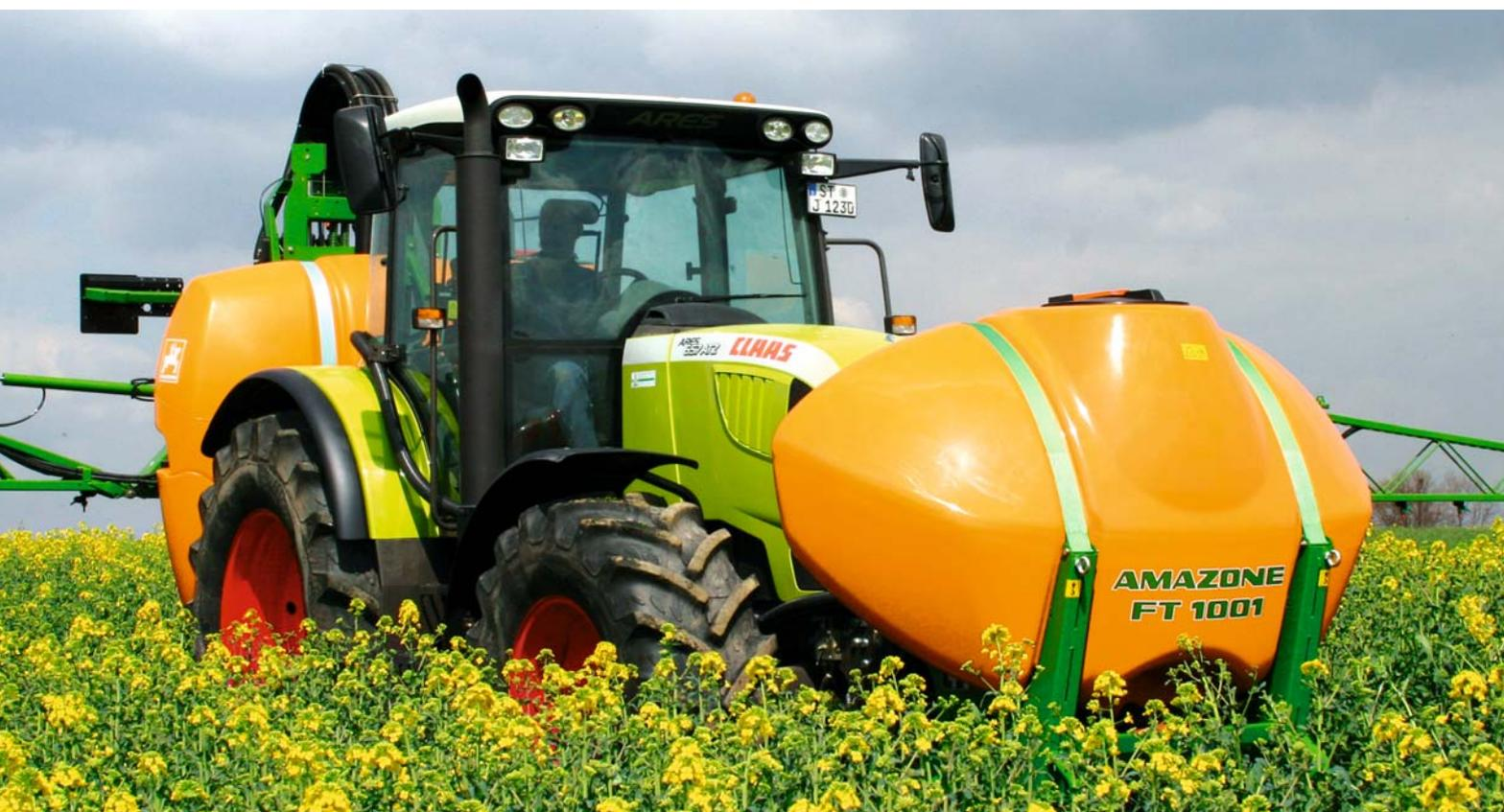
Явные преимущества маневренных тракторов с навесными агрегатами по сравнению с прицепными опрыскивателями, на небольших полях с неоднородной структурой, а также при движении по склону являются вескими аргументами в пользу фронтального бака.
